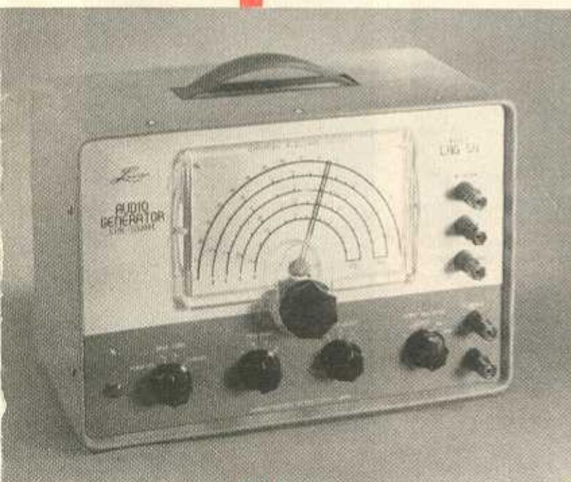
S'il est un appareil de mesure dont le spécialiste de la basse fréquence ne peut se passer que difficilement, c'est — à n'en pas douter — du générateur B. F. (sinusoidal et rectangulaire). Un tel générateur peut — selon la technique retenue — faire appel au battement de deux oscillateurs H. F., ou mieux mettre en œuvre des circuits R. C. (pont de Wien).
