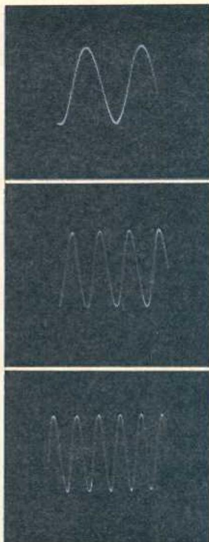
Grâce à la thermistance, les signaux sinusoïdaux relevés à diverses fréquences ont une amplitude remarquablement constante.
