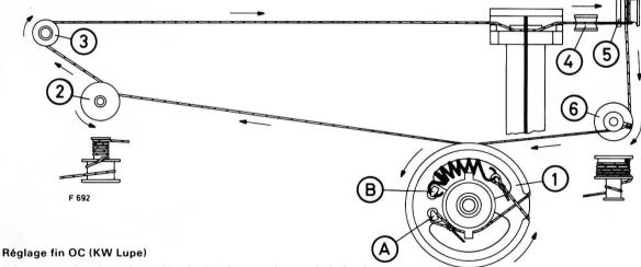
Faire un nœud en bout de corde et la tirer à travers le trou du levier. La molette de commande KW doit être en butée vers l'arrière. Enrouler la corde avec 3 tours autour de la moitié supérieure de l'axe (en passant par la fente voir fig. ci-dessous).
