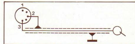
Los terminales están vistos por el lado de las soldaduras. El conductor central del cable blindado debe unirse al terminal n.º 3 del conector y la malla envolvente al terminal central (n.º 2).
