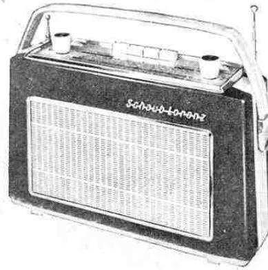
**Changement des piles:** La partie de dessous du coffret sera glissée vers la droite, de façon à rendre les piles accessibles. Changer ces piles, en respectant leur sens de montage figuré sur le couvercle coulissant.
