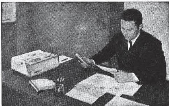
**USO DEL MICROFONO T 25** - Dopo avere collegato il microfono al registratore ed avere effettuato su quest'ultimo tutte le operazioni di inserimento alla rete-luce e di caricamento del nastro, premere il tasto rosso (registrazione) del G 681.
