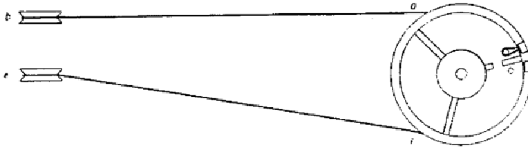
Seilzug für den Antrieb des UKW Eingangs- und Mischteilkästchens
