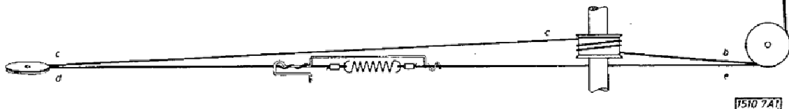
Seilzug für den Antrieb der Ferritantenne
