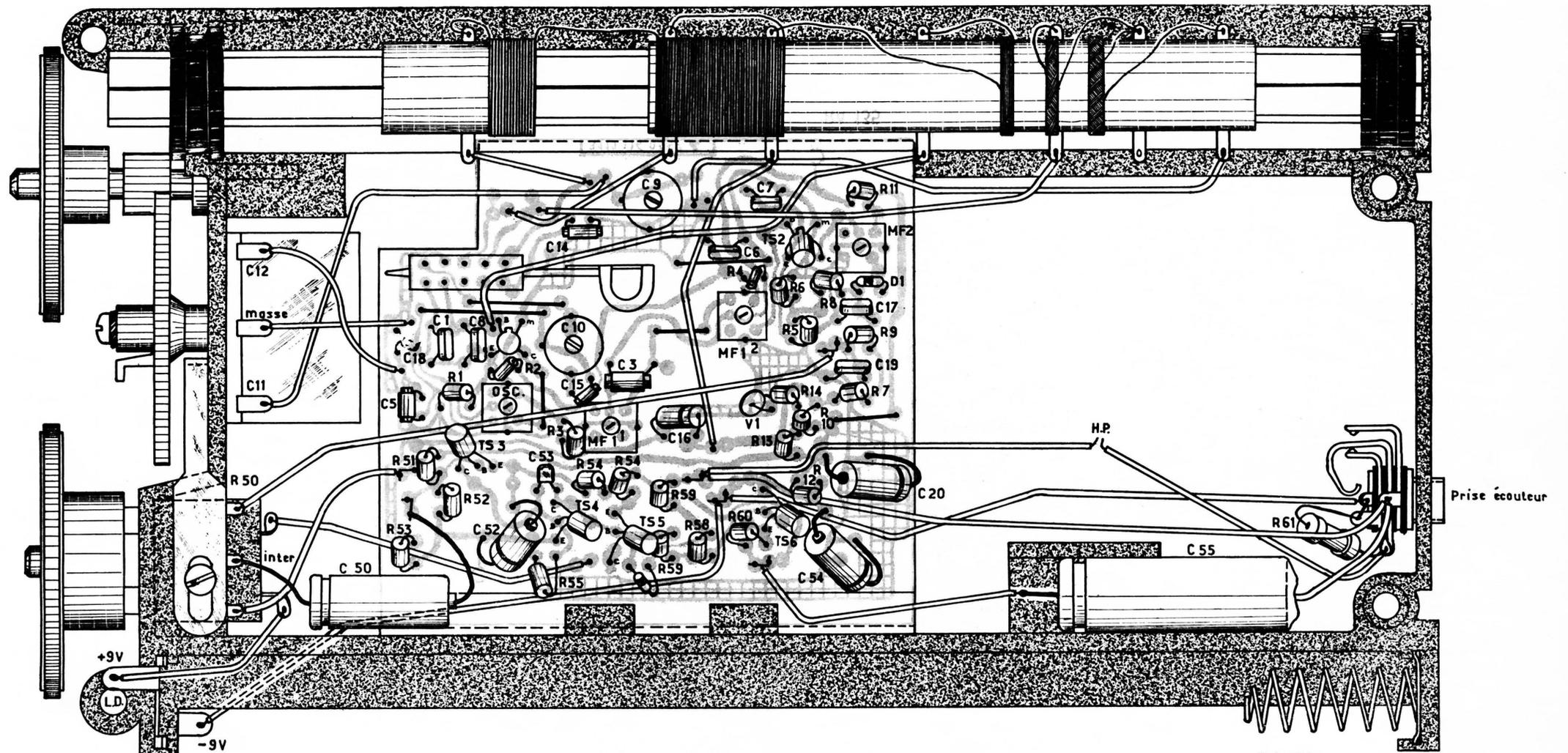
**ERRATUM :** L'indice de la résistance se trouvant entre l'émetteur de TS 5 est **R57** et non R54.
