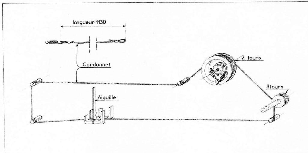
**NOTA.** — L'entraînement C. V. représenté ci-dessus est celui de la version table. Dans la version portable, les poulies sont déplacées, et le nombre de tours sur la poulie du C. V. est de 2 tours  $\frac{1}{2}$  position C. V. fermé.
