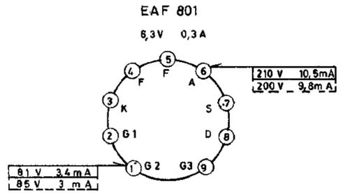
Spannungen mit Grundig Röhrenvoltmeter gemessen. Meßwerte gelten bei MW UKW TA ohne Signal an der Antenne.
