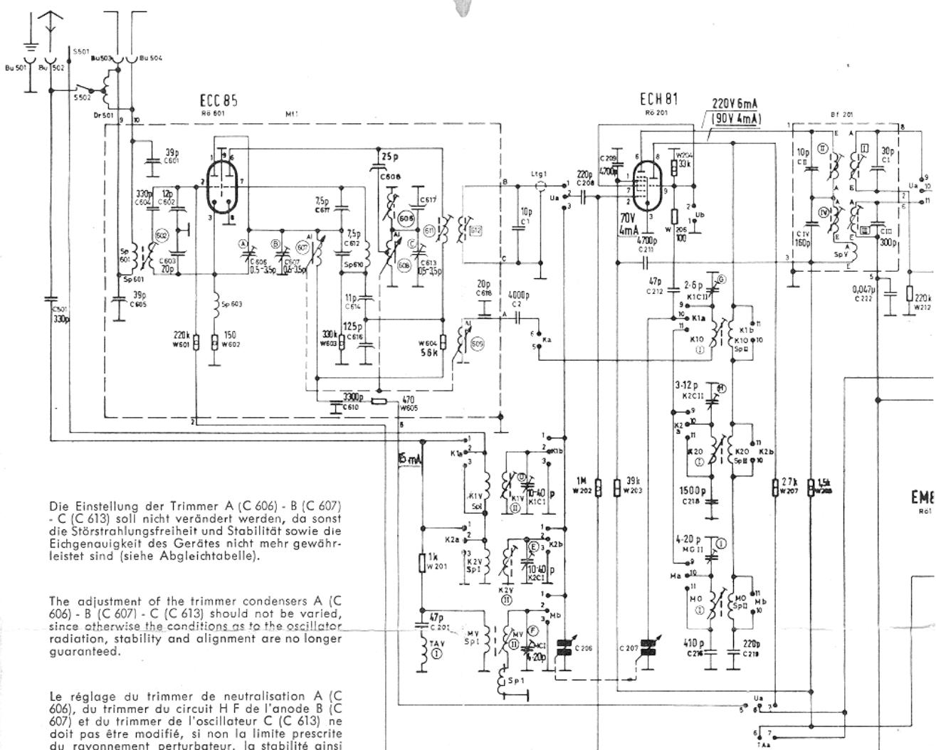
Die Einstellung der Trimmer A (C 606) - B (C 607) - C (C 613) soll nicht verändert werden, da sonst die Störstrahlungsfreiheit und Stabilität sowie die Eichgenauigkeit des Gerätes nicht mehr gewährleistet sind (siehe Abgleichtabelle).
