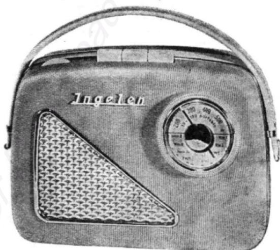
Überlagerungsempfänger für Mittelwellen ● 8 Transistoren
