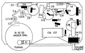
V3-35L6GT V4-35Z4GT. DIAL LAMP. VI -- 1457 V2-12J7GT G2 G4 G2 20V Gt G3 155 V 3MA 210V RMS 0 d 9 182V O 155V 0 ·4MA 5.4MA SIMA O Q<u>K</u>, O.V. 0 12 VOLT. 1557 HV. 2.2 W. 9MA H TOP CAP GRID. I.
