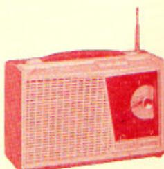
**RT044.** 7 transistors + germanium, 3 gammes. Prise antenne voiture, Antenne télescopique. Coffret gainé plastique 2 tons. H 180 - L 260 - P 100 mm. 2,1 kg.
