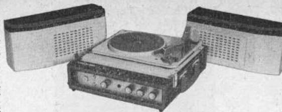
et aigus (amplitude 26 dB à 10 Kc/s). Contre-réaction sélective. Réglage de balance stéréo. Circuits imprimés. Voyant lumineux de mise sous tension. Platine changeur de disques 4 vitesses ELAC PW 160. Tête de PU stéréo, cellule piezo à 2 saphirs (microsillon compatible et 78 tours). Alternatif 110/240 V, 50 c/s, 63 VA. Valise gainée bleu nuit et gris clair, couvercle formant 2 baffles amovibles. H 185 - L 170 - P 360 mm, 9,40 kg. Prix T.L. en sus 651,53
