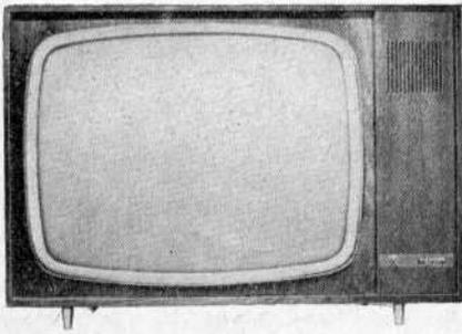
d'image par touche. Comparateur de phase incorporé. Antiparasite son automatique, antiparasite image réglable et commutable. Commande par claviers 4 touches. 2 HP. Puissance 2,5 W. Tonalité réglable par potentiomètre. Alternatif 110-240 V, 50 c/s. Ebénisterie noyer moyen verni, porte fermant à clé. H 600 - L 800 - P 410 mm.
