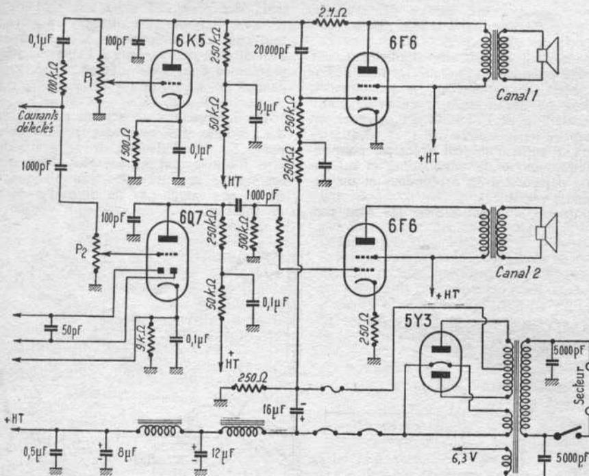
FIG. 7. — Exemple classique de montage de sortie à deux canaux pour radio-récepteurs.
