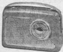
**Volltransistor.** 7 transistors + 2 germaniums. 2 gammes PO-GO. Cadre ferrite PO-GO incorporé. Prise coaxiale pour antenne voiture.
