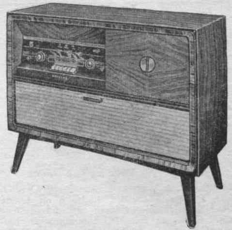
haute impédance. 2 réglages de tonalité : graves et aiguës, avec 3 boutons poussoirs : ambiance, orchestre, parole. Changeur de disques AG1014/45, 4 vitesses. Têtes de PU AG3025 Hi-Fi à pointe diamant et AG3010 à 2 saphirs. Alternatif 6 prises 117/245 V, 50 c/s, 75 + 8 VA. Meuble noyer, sur pieds. Changeur de disque latéral accessible par porte coulissante. H 822 - L 1 000 - P 392 mm.
