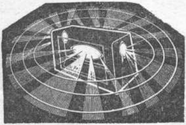
FIG. 1. — Disposition très schématique de trois haut-parleurs directionnels dans un radio-récepteur « 3 D ».
