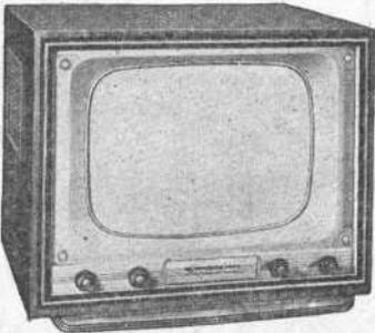
HD546. Tube de 54 cm. Rotacteur 6 positions, équipé pour 1 ou 2 canaux. 24 lampes + redresseur. Correction sur fréquence ligne pour grande distance. Anti-parasites son et image. HP 21 cm. Ebénisterie palissandre H550 - L700 - P550 mm.
