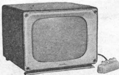
**Record.** Tube de 43 cm. Monocanal, bloc HF interchangeable. 13 lampes + redresseur. HP 17 cm. Ebénisterie noyer H480 - L500 - P570 mm. Avec commande à distance 4,5 m.
