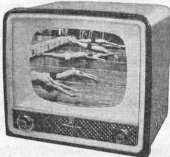
**RA4366.** Tube de 43 cm. Sélecteur 12 positions dont 11 équipées, Luxembourg sur demande. 18 lampes + germanium. Sensibilité 3 positions. Circuit anti-déchirement et anti-parasites son-image adaptables. HP elliptique 10-14 cm. Ebénisterie noyer. H500-L560-P430 mm.
