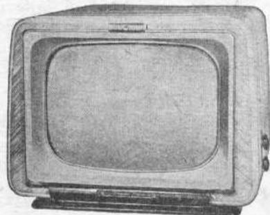
**SF 2357.** Tube de 54 cm. Rotacteur 6 positions dont 1 équipée. 21 lampes. Commande automatique de gain. Comparateur de phase. Anti-parasites son-image. HP elliptique 12-19 cm. Prise pour commande à distance. Ebénisterie noyer H520 - L700 - P570 mm.
