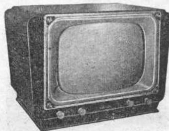
643T3. Tube de 43 cm. Rotacteur 6 positions, équipé suivant région. 19 lampes + redresseur. Antiparasites image. HP elliptique 13-19 cm. Ebénisterie noyer. H445-L580-P540 mm. Prix T.T.C. 118.251
