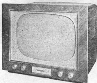
**T 1546 R.** Tube de 54 cm. Rotacteur 6 positions, dont 1 équipée. 20 lampes + 2 redresseurs. Comparateur de phase. Commande automatique de gain. Prise PU avec commutateur mettant hors circuit les lampes inutilisées. HP 19 cm. Ebénisterie façade noyer, acajou ou palissandre. H560-L675-P655 mm. 176.081
