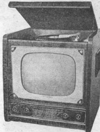
**43P457.** Combiné TV-radio-phon. Tube de 43 cm. Rotacteur 6 positions dont 1 équipée, 20 lampes + germanium. Sensibilité 3 positions. Radio 4 gammes OC-PO-GO-BE. Cadre ferroxcube. Tourne-disque 3 vitesses. 2 HP de 13 cm. Tonalité réglable. Ebénisterie noyer ou palissandre H580-L570-P480 mm. Prix T.T.C. 159.386
