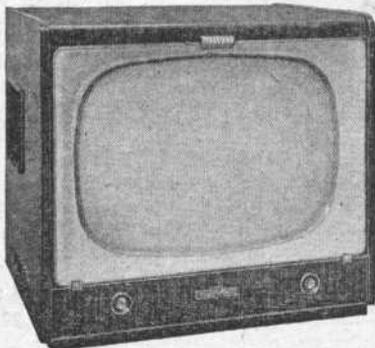
**54-256.** Tube de 54 cm. Rotacteur 6 positions dont 1 équipée, 17 lampes + germanium.
