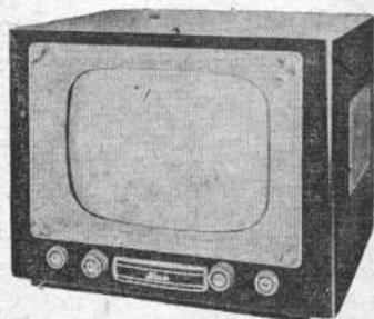
**BL43.** Tube de 43 cm aluminisé. Multicanal Rotacteur 6 positions, équipé pour 1 canal du standard français 819 lignes, ou Luxembourg (canaux supplémentaires sur demande). 18 lampes + germanium. Sensibilité 50  $\mu$ V. Correcteur vidéo commutable. Platine longue distance avec comparateur de phase, et anti-parasites image adaptables. HP 17 cm. Puissance 1,8 W. Alternatif 110/245 V, 50 c/s, 140 VA. Ebénisterie noyer, encadrement doré, H 440 - L 520 - P 460 mm, 24 kgs. Prix T.T.C. **97.688**
