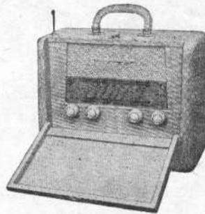
**Piles-secteur G.M.** 7 lampes (2-1T4, DK92, 1S5, 5Q4, 50B5, 35W4), 4 gammes OC - PO - GO - BE. Antenne télescopique. HP elliptique 13-17 cm. Tonalité réglable. Pile bloc 9 V 50 mA et 90 V 12 mA, ou secteur alternatif. Valise gainée beige H225 - L320 - P150 mm.
