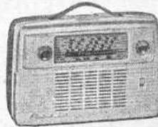
**Poste à piles 4 lampes** (DK92, 1T4, 1S5, DL92), 2 gammes PO - GO. Cadre ferrite. HP 10 cm. 2 piles 1,5 V 180 mA et pile 67,5 V 10 mA. Coffret matière moulée ivoire H160 - L220 - P80 mm.
