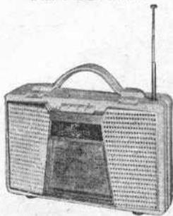
46 : Poste à piles 4 lampes (DK96, DF96, DAF96, DL96), 4 gammes OC - PO - GO - BE. Cadre ferroxcube et antenne télescopique. Clavier 4 touches. HP 10 cm., 2 piles 1,5 V 125 mA et pile 90 V 12 mA. Possibilité d'alimentation secteur par socle se plaçant sous l'appareil. Polystyrène crème et ivoire. H200-L270/280-P111 mm. Prix T.C.C. 21.883
