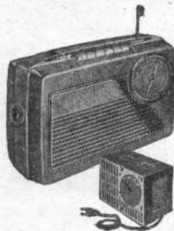
Pygmy-Golf. Poste à piles 6 lampes (DK96, 2-DF96, DAF96, DL96, DM70). Etage HF accordé. 6 gammes OC1-OC2-OC3-OC4-PO-GO. 6 boutons poussoirs. Cadre ferroxcube et antenne télescopique. HP elliptique 10-14 cm. 3 piles 1,5 V 175 mA et pile 90 V 11 mA. Position économique 8,5 mA. Possibilité d'alimentation secteur par adjonction d'un bloc incorporable. Coffret 2 coquilles ivoire, vert, bordeaux ou gris perle, H195-L280-P98 mm.
