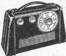
**Transivox.** Poste à piles à 8 transistors : 4 transistors haute fréquence spéciaux, 1 diode au germanium, 4 transistors basse fréquence : deux OC71, deux OC72 en étage final push-pull class B. Cadre incorporé PO-GO sur ferrite. Superhétérodyne. Alimentation totale par 4 piles torche 1,5 V. Dimensions : 60x140x220 mm.
