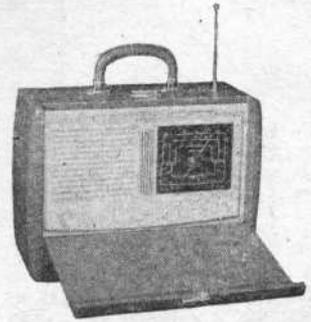
**5625 PS.** Poste piles-secteur. 5 lampes (DK92, IT4, IS5, 3Q4, 117Z3). 4 gammes OC - PO - GO - BE. Cadre ferroxcube et antenne télescopique. HP 127 mm. Pile 4,5 V 100 mA et pile 90 V 14,5 mA (position économique 10 mA). Tous courants continu ou alternatif. Valise gainée H240-L320-P140 mm.
