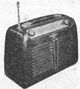
**Week-End,** poste piles-secteur 5 lampes + redresseur (DK92, IS5, 2-IT4, 3Q4, redr. Sélénium. Etage HF 3 gammes OC - PO - GO. Cadre incorporé et antenne télescopique. HP 90 V 14 mA. Tous courants continu ou alternatif. Coffret plastique bordeaux H2220-L305 P135 mm.
