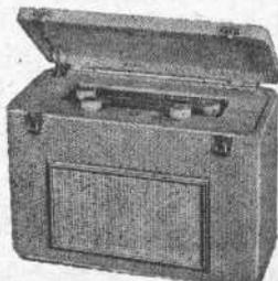
**Ambiance II.** Poste à piles 5 lampes (2-1T4, DK92, 1S5, 3Q4). Etage HF accordé. 3 gammes OC - PO - GO. Cadre ferrox-cube et antenne télescopique. HP 12 cm. Tonalité réglable. 2 piles 1,5 V 300 mA et pile 90 V 19 mA. Position économique 250 mA et 12 mA. Possibilité d'alimentation secteur par bloc incorporable. Valise gainée H210-L300-P150 mm.
