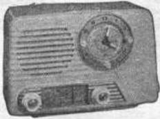
**New-Clock.** Poste pendule 5 lampes (12AJ8, 12 BA6, 12AT6, 35W4,50 B5), 4 gammes OC-PO-GO-BE. Cadre ferriloop. HP10 cm. Pendule avec dispositif marche-arrêt radio, ronfleur-réveil et prise 5A à contact automatique. Pollopas ivoire H170-L250-P110 mm.
