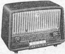
**BF 360A.** 4 lampes (UCH81, UBF80, UCL82, UY85). 4 gammes BE - OC - PO - GO. Ferrocapteur, et antenne OC incorporée. Clavier 5 touches dont 1 arrêt secteur, et combinaisons par 2 touches pour gamme Chalutier (adaptable sur demande) et commutation PU. HP 13 cm. Tonalité réglable. Polystyrène bordeaux ou ivoire. H220-L330-P165 mm.
