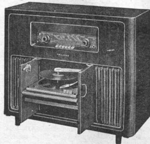
**FX 652 AM/FM.** 11 lampes (ECC85, ECH81, EF89, EF85, EABC80, ECC83, 2-EL84, 2-EZ80, EM80). 4 gammes OC-PO-GO-FM. Ferrocapteur et antenne OC-FM incorporée. Clavier 6 touches dont arrêt-secteur. 2 canaux BF agissant sur 2 HP 17 et 21 cm. 2 réglages de tonalité. Changeur de disques 3 vitesses. 2 têtes de PU haute fidélité et pointe diamant. Meuble noyer, H827-L1150-P420 mm.
