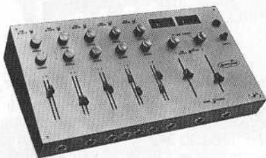
sensibilité minimale de 2 mV pour 1 V de sortie. Contrôles graves-aigus séparés sur chaque voie  $\pm 15$  dB (système Baxandall). Prêécoute sur chaque voie. Sortie casque stéréo pour contrôle. 2 vu-mètres. Entrées : micro-PU magnétique. Tuner magnétophone. Dimensions : 520 x 260 x 100 mm.
