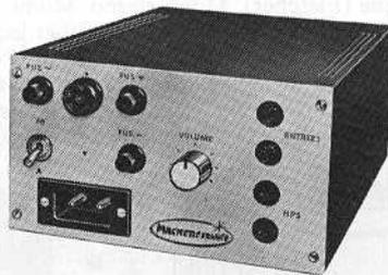
Module amplificateur 80 W efface sortie : 8  $\Omega$ . Courbe de réponse de 20 à 50 000 Hz.  $\pm 2$  dB à 40 W. 20 à 30 000 Hz  $\pm 2$  dB à 80 W. Sensibilité d'entrée : 800 mV. Distorsion : 1% à 80 W. Rapport signal/bruit : - 80 dB. Dimensions : 250 x 200 x 120 mm. Poids : 5,600 kg.
