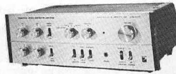
30 W et 0,15 % à 25 W. Bande passante : 15 à 30 kHz à ± 1 dB. Bruit résiduel : 75 dB. Diaphonie : 50 dB à 1 kHz. Contrôles de tonalité. Filtrage passe-haut et passe-bas. Correcteur physiologique. Sensibilité entrée : PU : 2 mV/50 kΩ. Tuner : 120 mV/50 kg. Auxiliaire : 120 mV/50 kΩ. Magnétophone : 120 mV/50 kΩ. Rapport signal/bruit, PU : 60 dB. Tuner : 65 dB. Auxiliaire : 65 dB.
