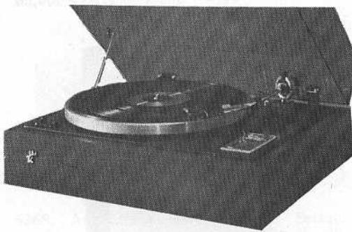
110/130-220/240 V, 50 ou 60 Hz. Rapport signal/bruit : meilleur que 40 dB. Glissement : inférieur à 0,7%. Bras tubulaire de 220 mm. Erreur de tracking : 3,5° max. Tête de lecture électromagnétique. Réponse en fréquence : 20 Hz à 20 000 Hz. Tension de sortie : 5 mV. Diaphonie : meilleure que 25 dB à 1 kHz. Force d'appui optimale : 2,5 g. Pointe à diamant sphérique. Compliance :  $7 = 10^{-6}$  cm/dyne. Impédance : 50 k $\Omega$ . Dimensions : 19 x 44 x 35 cm. Poids : 9,8 kg.
