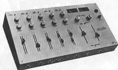
sensibilité minimale de 2 mV pour 1 V de sortie. Contrôles graves-aigus séparés sur chaque voie  $\pm 15$  dB (système Baxandall). Précoute sur chaque voie. Sortie casque stéréo pour contrôle. 2 vu-mètres. Entrées : micro-PU magnétique. Tuner magnétophone. Dimensions : 520 x 260 x 100 mm.
