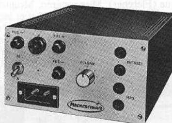
Module amplificateur 80 W effiace sortie : 8  $\Omega$ . Courbe de réponse de 20 à 50 000 Hz.  $\pm 2$  dB à 40 W. 20 à 30 000 Hz  $\pm 2$  dB à 80 W. Sensibilité d'entrée : 800 mV. Distorsion : 1% à 80 W. Rapport signal/bruit : - 80 dB. Dimensions : 250 x 200 x 120 mm. Poids : 5,600 kg.
