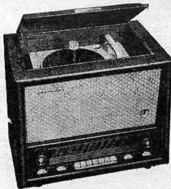
FM. Cadran glace incliné. Indicateur visuel d'accord. 3 HP : 21 cm, 9 cm et tweeter électrostatique 6 cm. Puissance 3,5 W. Prise HPS basse impédance. 2 réglages de tonalité : graves et aiguës. Contre-réaction sélective. Tourne-disques 4 vitesses. Alternatif 110/245 V, 50 c/s, 80 + 15 VA. Ebénisterie noyer à bords arrondis, filets laiton poli. H 390 - L 560 - P 290 mm, 14,6 kg.
