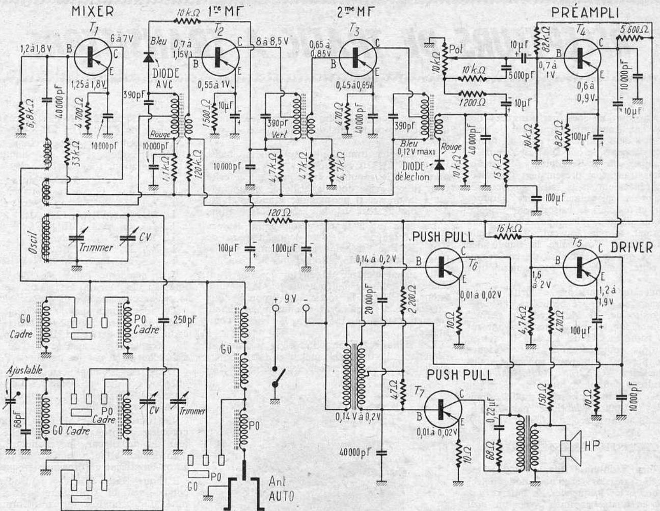
Fig. 3. — Schéma d'un récepteur à 7 transistors, avec prise d'antenne auto
