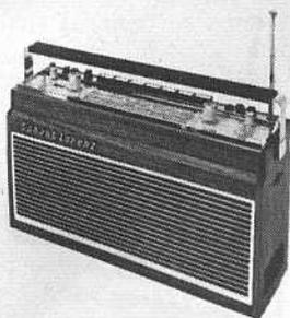
OC. Cadre ferrite PO-GO. 2 antennes télescopiques orientables en FM. Prise antenne voiture commutée. Prises PU, magnétophone, écouteur ou HPS (avec coupure du HP incorporé). Réglage de tonalités graves et aiguës séparés. Indicateur d'accord et d'usure de piles. Eclairage cadran. HP de 130 x 180 mm. Puissance 2,5/6 W. Alimentation : 5 piles de 1,5 V ou par bloc secteur NG1001 ou sur voiture par la batterie. Coffret ébénisterie bois ciré mat. L 310 - P 92 - H 193 mm. Poids 3,5 kg env.
