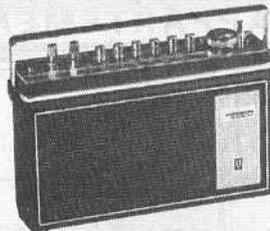
FM. OC1 et OC2. Haut-parleur 120 x 190 mm assurant un haut rendement musical. Prise d'écouteur extérieur. Prise magnétophone. Prise sortie adaptateur secteur. Gammes couvertes : GO : 148 Kcs (2 000 m) à 274 Kcs (1 100 m) ; PO : 520 Kcs (576 m) à 1 620 Kcs (185 m) ; OC1 : 2,3 Mcs (130 m) à 7 Mcs (42 m) ; OC2 : 6,75 Mcs (44 m) à 20 Mcs (15 m) ; FM : 87 à 108 Mcs.
