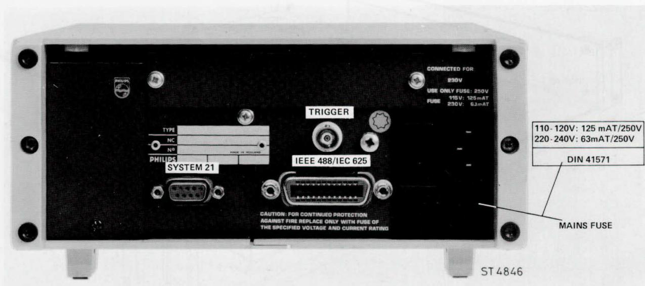
Abb. 3.1 Lage der Netzsicherung
