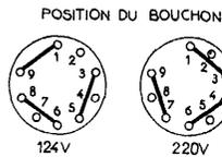
**EXÉCUTION U :** — Le schéma ci-dessus, en position 124 V, est valable, à l'exception du transformateur S11 à S13, du carrousel et du condensateur C25, qui sont supprimés.
