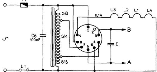
**COMMUTATION :** — Le commutateur est représenté en position P.O. En G.O. les contacts mobiles sont poussés dans la direction indiquée par les flèches.
