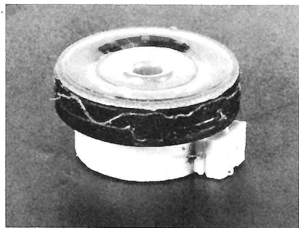
Fig. 2. — Ensemble moteur de la capsule transductrice, sans écran antérieur protégé-diaphragme. On y aperçoit nettement le diaphragme en mylar avec sa partie centrale en calotte sphérique, entourée d'un anneau flexible bombé vers l'extérieur; ainsi que l'ouverture du tube traversant axialement l'aimant de part en part.
