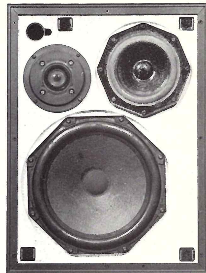
Fig. 2. — Vue, grille protectrice enlevée, de la face antérieure de l'enceinte acoustique « 22 RH 532 », avec ses trois haut-parleurs : l'élément grave est un haut-parleur de diamètre 20 cm (AD 8065), dont la bobine mobile est solidaire de l'accéléromètre piézoélectrique, dissimulé par le dôme anti-poussières, l'élément médial, à diaphragme conique de diamètre 12,5 cm (AD 5060); le tweeter rayonne son énergie acoustique par un diaphragme en calotte hémisphérique, de diamètre 2,5 cm. Dans le coin supérieur gauche, s'aperçoit le logement du voyant lumineux signalé, figure 1.
