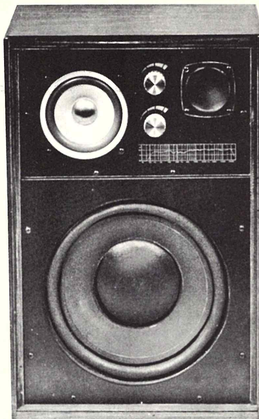
Fig. 1. — L'enceinte asservie type Andante. Cette « petite » enceinte, dont la plus grande dimension n'est que de 48 cm, contient un amplificateur de 120 watts.
