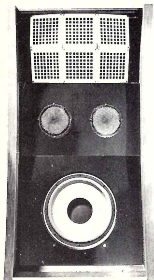
Vue de l'enceinte acoustique S.A.E. A noter la disposition des tweeters électrostatiques au sommet de l'enceinte.
