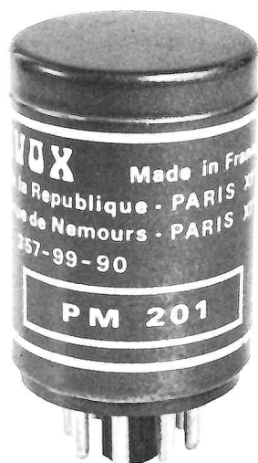
Fig. 3a. — Aspect extérieur de l'amplificateur enfichable « PM 201 ». Le circuit est immobilisé par une résine epoxy dans un boîtier cylindrique en aluminium (hauteur 50 mm, diamètre 30 mm). On retrouve la même présentation pour l'amplificateur de mélange APM, ainsi que pour les transformateurs symétriques d'entrée ou de sortie.
