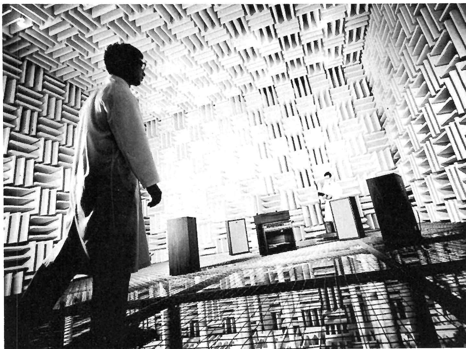
Fig. 2. — Chambre sourde du Centre de recherches acoustiques
