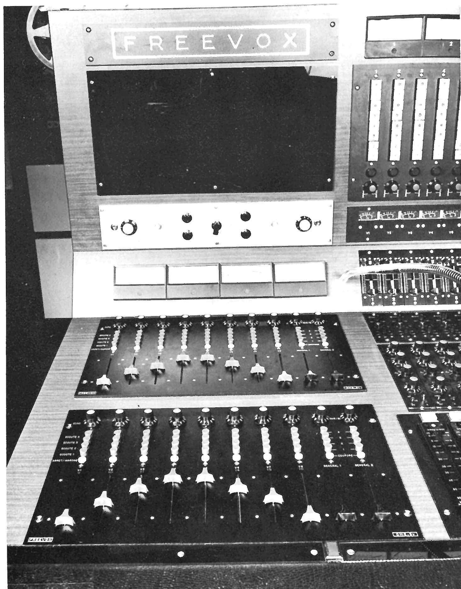
Fig. 14b. — En vue du travail en quadriphonie la console de mélange de la figure 1 comporte deux consoles de mélange d'écoute à 8 canaux (réglables individuellement avec possibilité d'introduire l'écho sur chaque voie), quatre VU-mètres de contrôle et deux réglages « généraux » du niveau d'écoute, par console.
