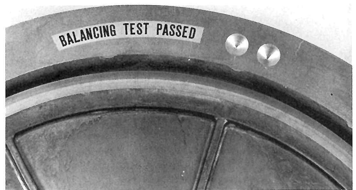
Fig. 2. — Vue partielle de la partie inférieure du plateau, montrant les traces laissées, lors de son équilibrage dynamique.
