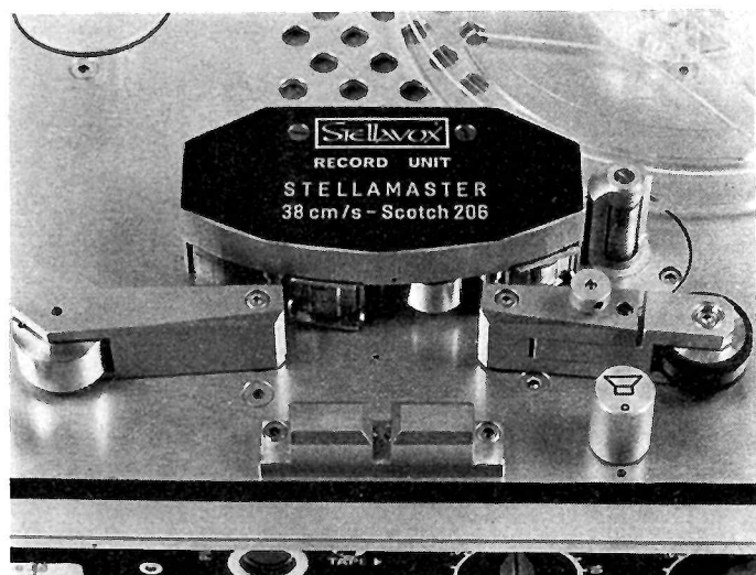
Fig. 5. — Vue du bloc de têtes, du cabestan.
