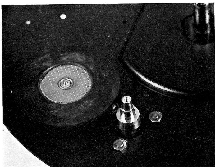
Fig. 3. — Vue de l'axe d'entraînement du moteur et du galet intermédiaire.
