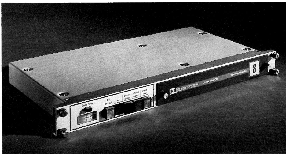
Fig. 16. — L'appareil A 361 muni d'un émetteur de signal pilote.
