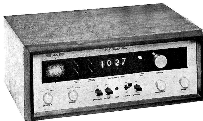
Le récepteur MF digital Mark VI. On notera l'indication lumineuse de la fréquence par tubes nixie et à gauche l'image donnée par un petit tube cathodique indiquant, dans le cas de la figure, une émission stéréophonique.
