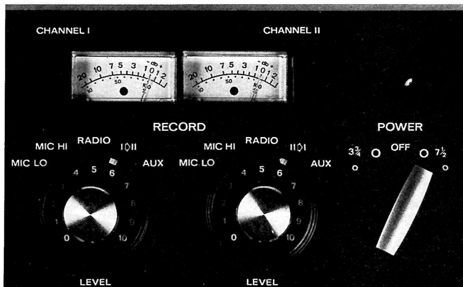
Fig. 3. — Les VU-mètres, les boutons de sélection des entrées et du réglage des niveaux d'enregistrement, du sélecteur de vitesse.
