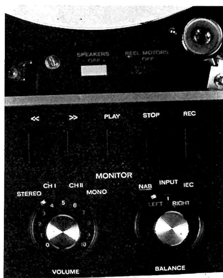
Fig. 2. — Vue du clavier de commande du transport de la bande, des boutons de sélection, du mode de fonctionnement, des niveaux de lecture, du commutateur Direct-Enregistré (NAB ou IEC), du bouton de balance.
